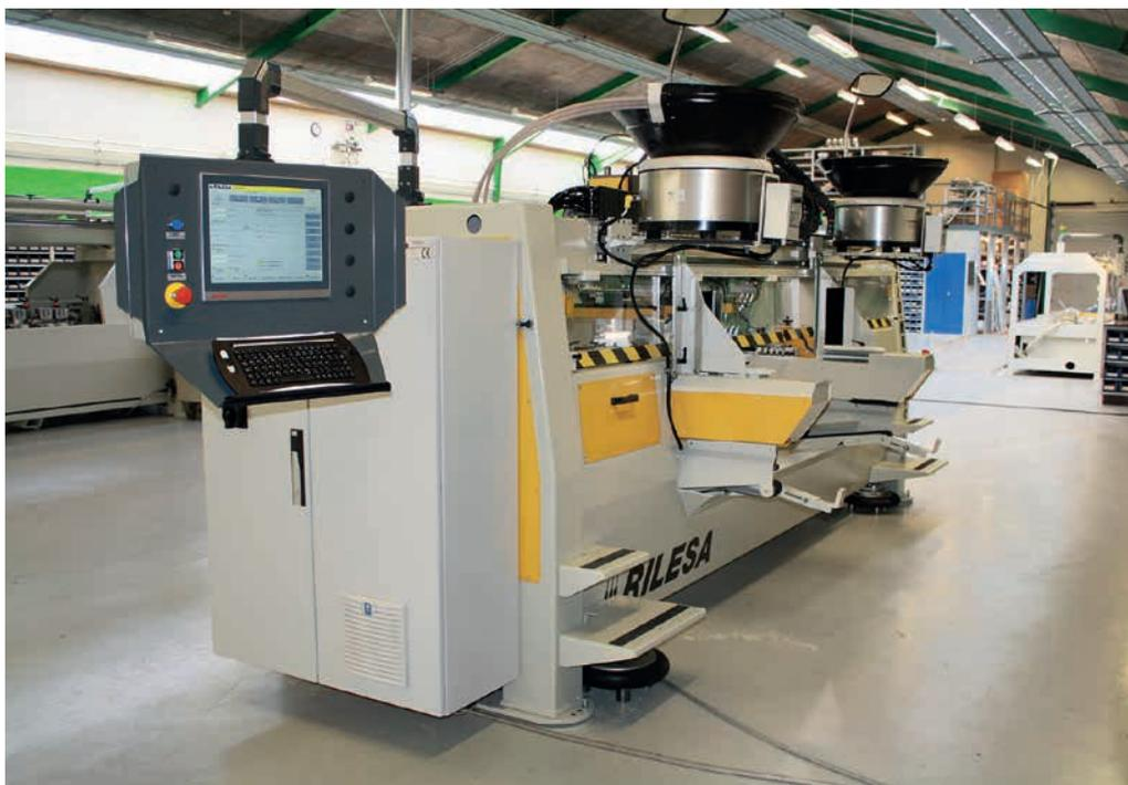
◀ Kann mit verschiedenen Bohr- aggregaten und -köpfen sowie optional mit Leim- und Dübel- einheiten ausgerüstet werden: die Einstiegsbohrmaschine Rapid (Fotos: Rilesa)
