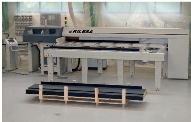
Optional kann die Proline kundenindividuell mit weiteren Achsen und CNC-gesteuerten Bohr- oder Fräsaggregaten ausgerüstet werden. Die Programmierung und Bedienung erfolgt über eine Beckhoff-Steuerung, mit der zudem eine Störungssuche und Störungsbehebung über Fernwartung möglich ist.
