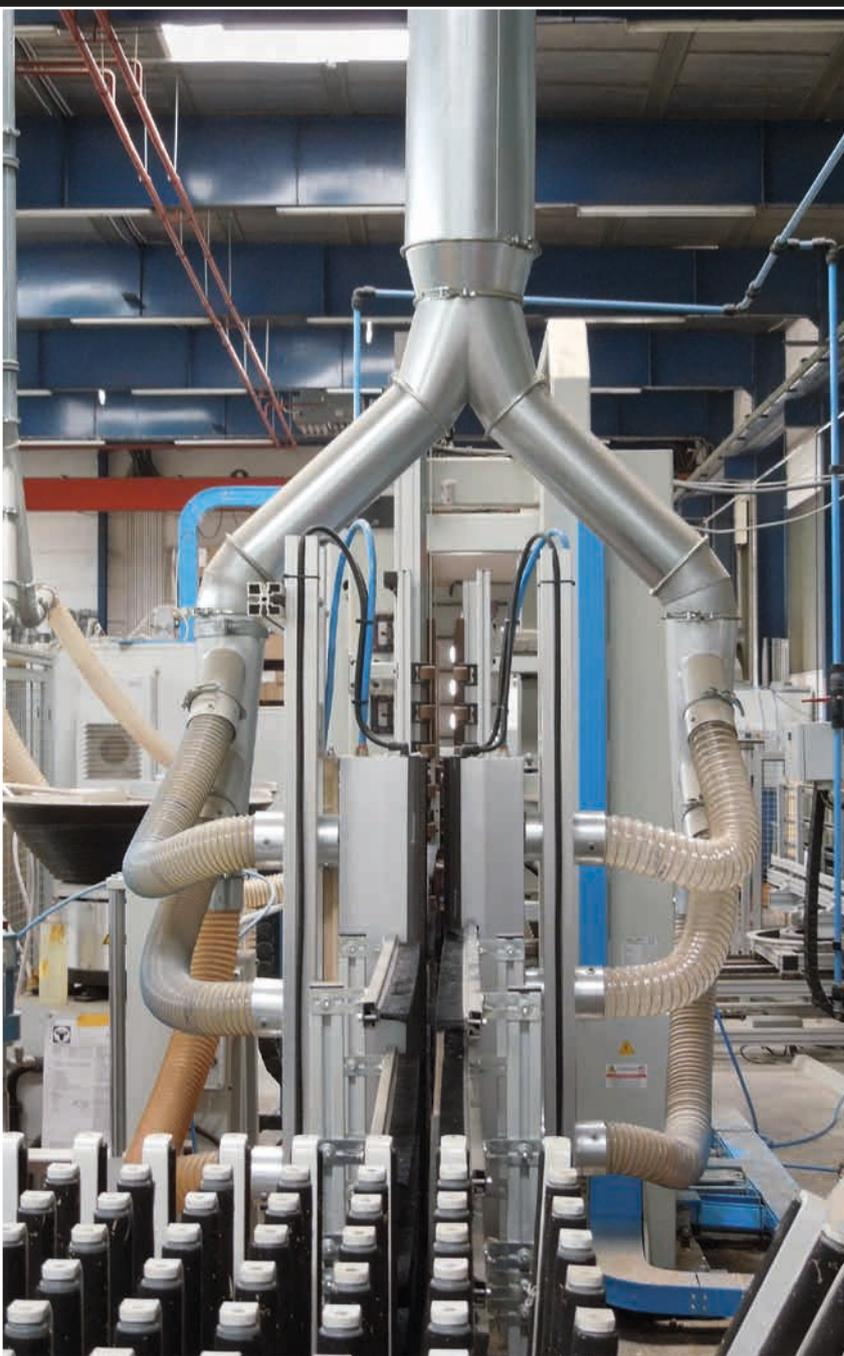
▲ (li.) Rückansicht einer Biess CNC-Durchlaufbohrmaschine Modell FTT, mit 3 Reinigungseinheiten, „EWAE“ einzeln zuschaltbar, je nach Werkstückbreite
