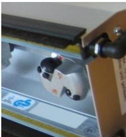
Die kompakte EWAE Einheit zur elektrischen Entladung und nachfolgender Reinigung von mit Kunststoff Beschichteten Spanplatten oder lackierten Oberflächen, Im Durchlauf., Kann an Durchlaufmaschinen unterschiedlichster Fabrikate Und Ausführungen angebaut werden
